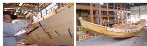
15〜30人乗りの鵜飼観覧船は、「屋形」と呼ぶ屋根を柱を立てて載せるなど他の船にはない構造になっている。写真左は「モジ」と呼ばれる道具で釘穴を打っている様子。
